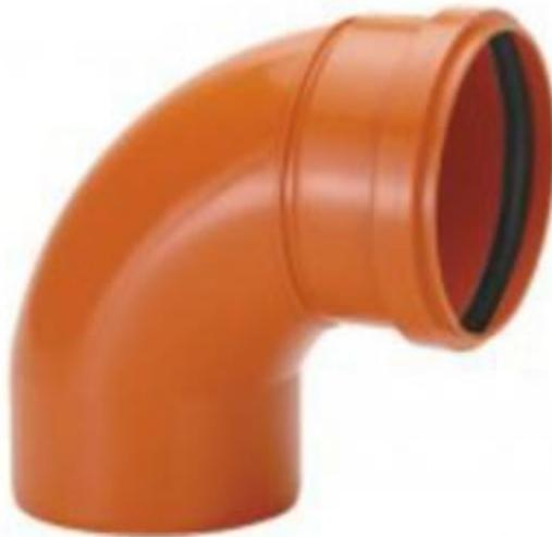
Imagem de referência curva curta PVC, PB, JE, 90 graus, DN 100 mm, para rede coletora esgoto (NBR 10569)
